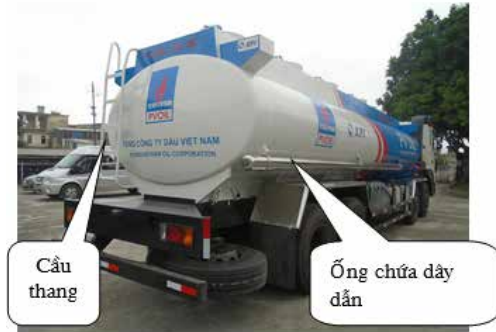
Đầu sau xe có bố trí 1 cầu thang lên xuống và ống để dây dẫn 2 bên sườn
