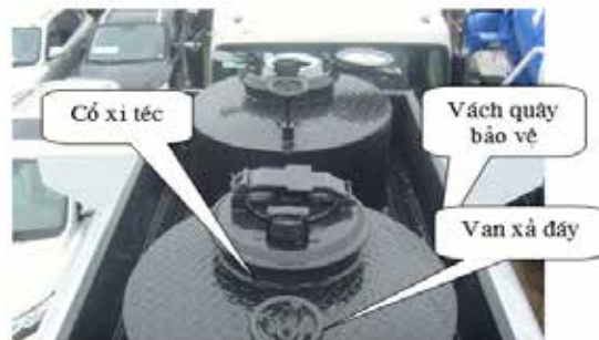
Cổ téc đảm bảo kín khít và tôn chống trượt, vách quay đảm bảo an toàn cho người sử dụng
